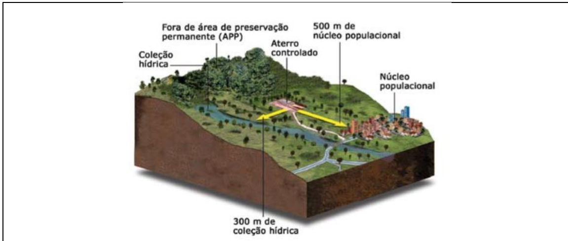
Figura 29 – Critérios a serem observados para a definição de área para implantação de aterro de pequeno porte
